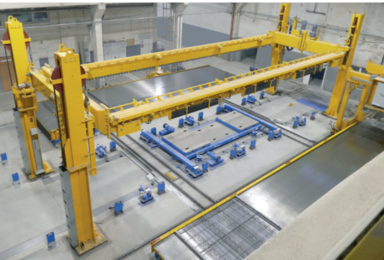
托盘翻转装置是流水线工厂双层墙生产的新亮点
