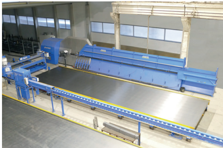
Progress Maschinen & Automation 提供的 Pluristar 是一种集自动箍筋弯曲机、矫直机和双弯曲机于一体的设备。它完美地融入了新的 Ebawe 流水线工厂
