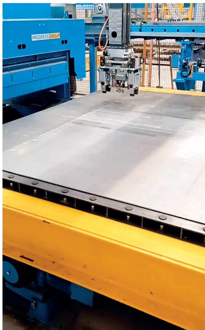
Oznaczenia niezbędne do wstawiania elementów szalunku są precyzyjnie wykonywane za pomocą zintegrowanego oprogramowania i precyzyjnych laserów.
