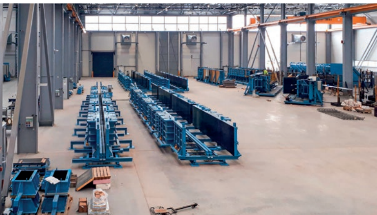
Hala fabryczna Viastein Kft. z formami do produkcji słupów, dźwigarów i schodów.
