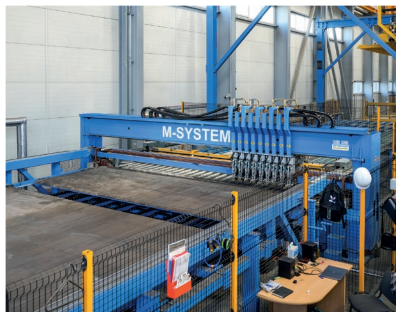
Automatyczny system zgrzewania siatek M-System wykorzystuje stal w kręgach i oferuje wysoką wydajność oraz bardzo dużą elastyczność w produkcji siatek.
