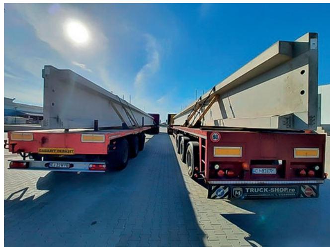
Dźwigary i słupy są produkowane w zakładzie, a następnie w wygodny i szybki sposób montowane na placu budowy.
