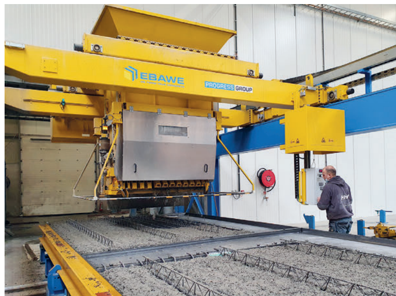
Der Betonverteiler befüllt die geschalteten Paletten nach dem Einlegen der maßgefertigten Bewehrungselemente mit Frischbeton.
