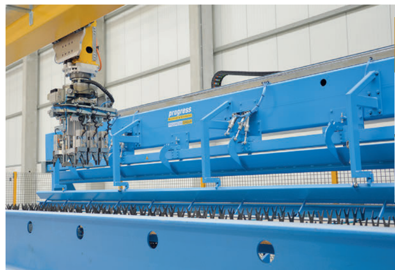
Das vollautomatische Verlegen von Bewehrungselementen mit dem Wire Center ermöglicht eine Steigerung der Produktionsleistung.
