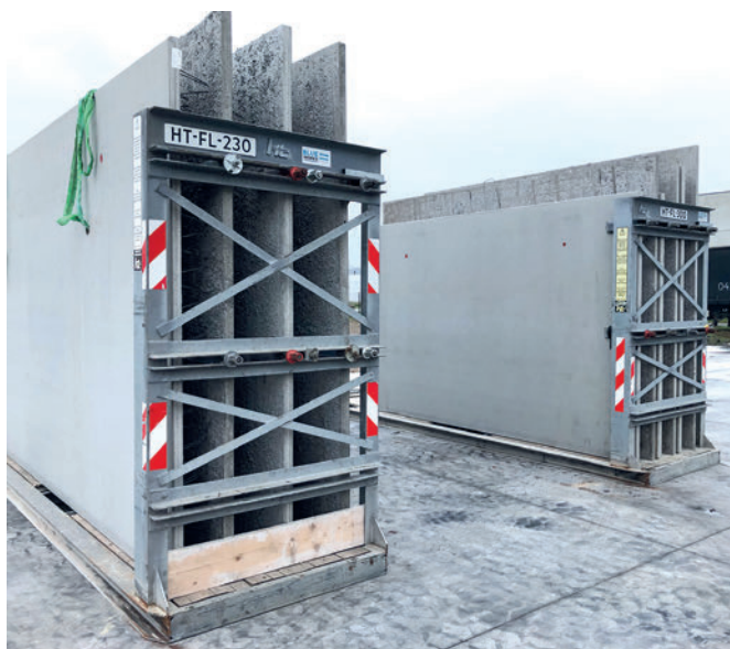
Für den Abtransport zur Baustelle vorbereitete Doppelwandelemente
