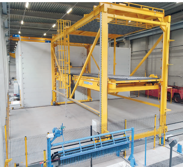
Das Regalbediengerät zum automatischen Stapeln und Entstackeln von Paletten wird über ebos® gesteuert.
