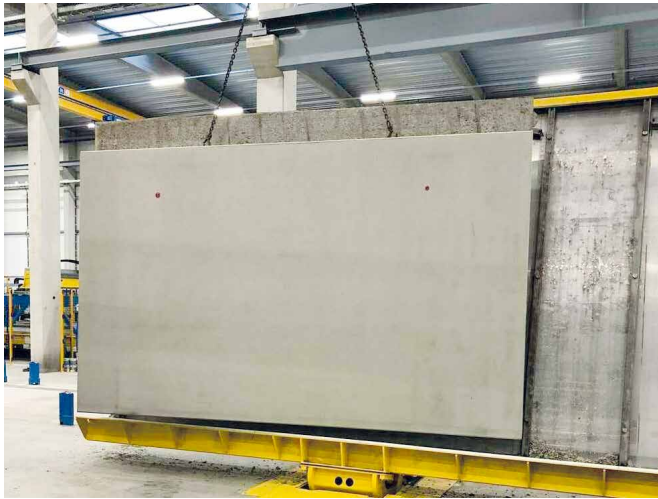
生产第一个双层墙
