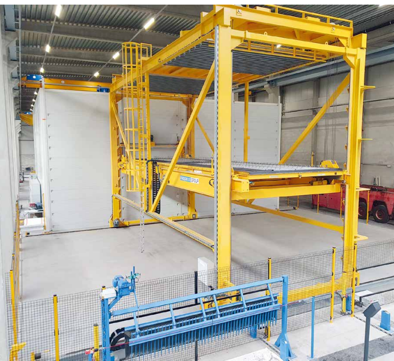
通过 ebos® 软件实现全自动托盘堆垛和卸垛的托盘堆垛机
