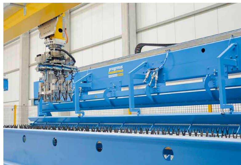
Wire Center 可自动放置钢筋，提高了产量
