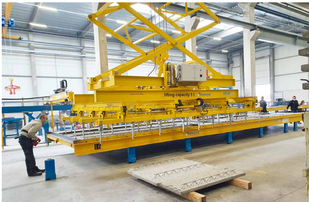
脱模起重机可在不破坏构件的情况下将其移除
