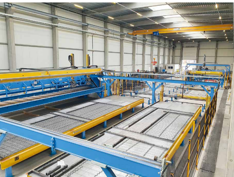
工厂的放大图，该工厂有自动线材处理车间以及配备托盘清洁设备的全自动模板机器人
