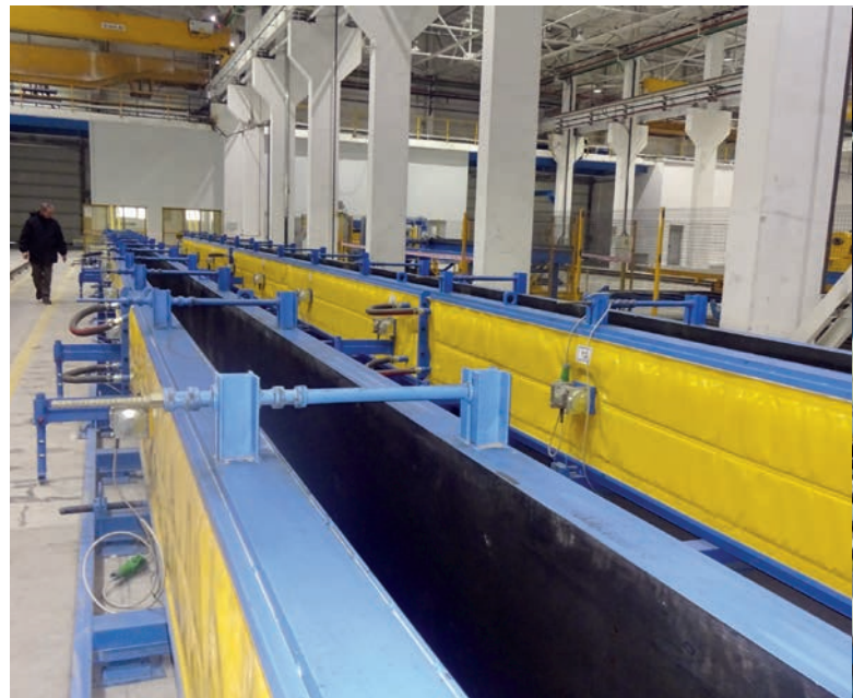
模板专家 Tecnomat 为梁和柱的生产提供电池模具和模板
