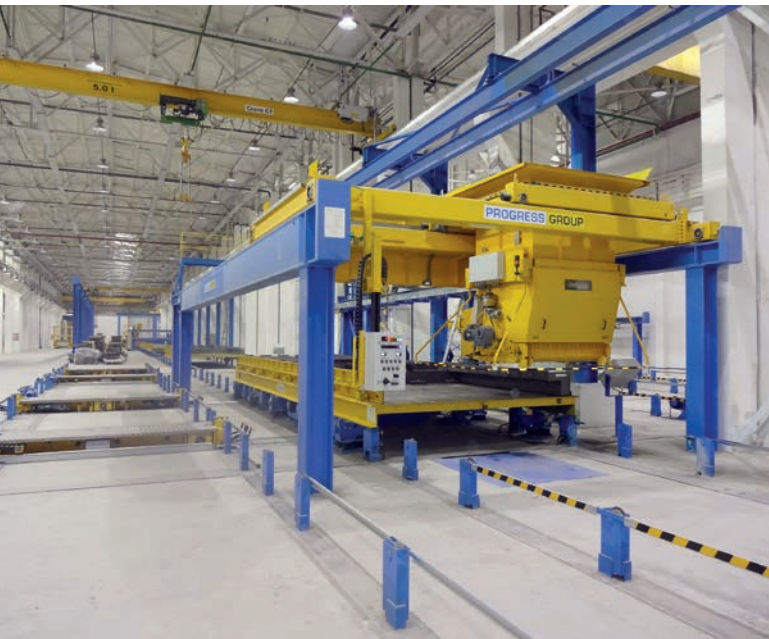
Ebawe Anlagentechnik 生产的托盘转动设备共有 41 个生产托盘供 Erel 使用
