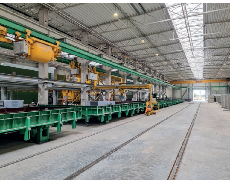
Stoły uchylne służą do produkcji wielkowymiarowych płaskich prefabrykatów betonowych, takich jak ściany pełne lub ściany warstwowe.
