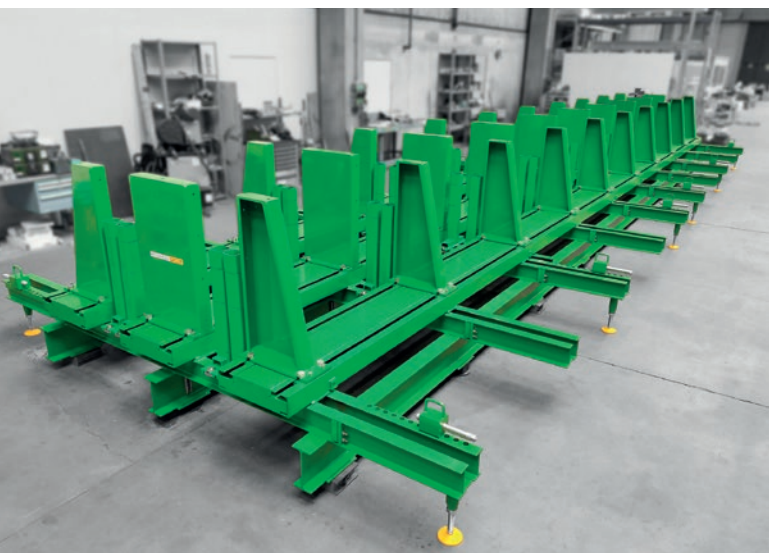
Bateryjne formy dwuelementowe są wykorzystywane do produkcji najlepiej sprzedającego się towaru – słupów – i mają długość 14 metrów.
