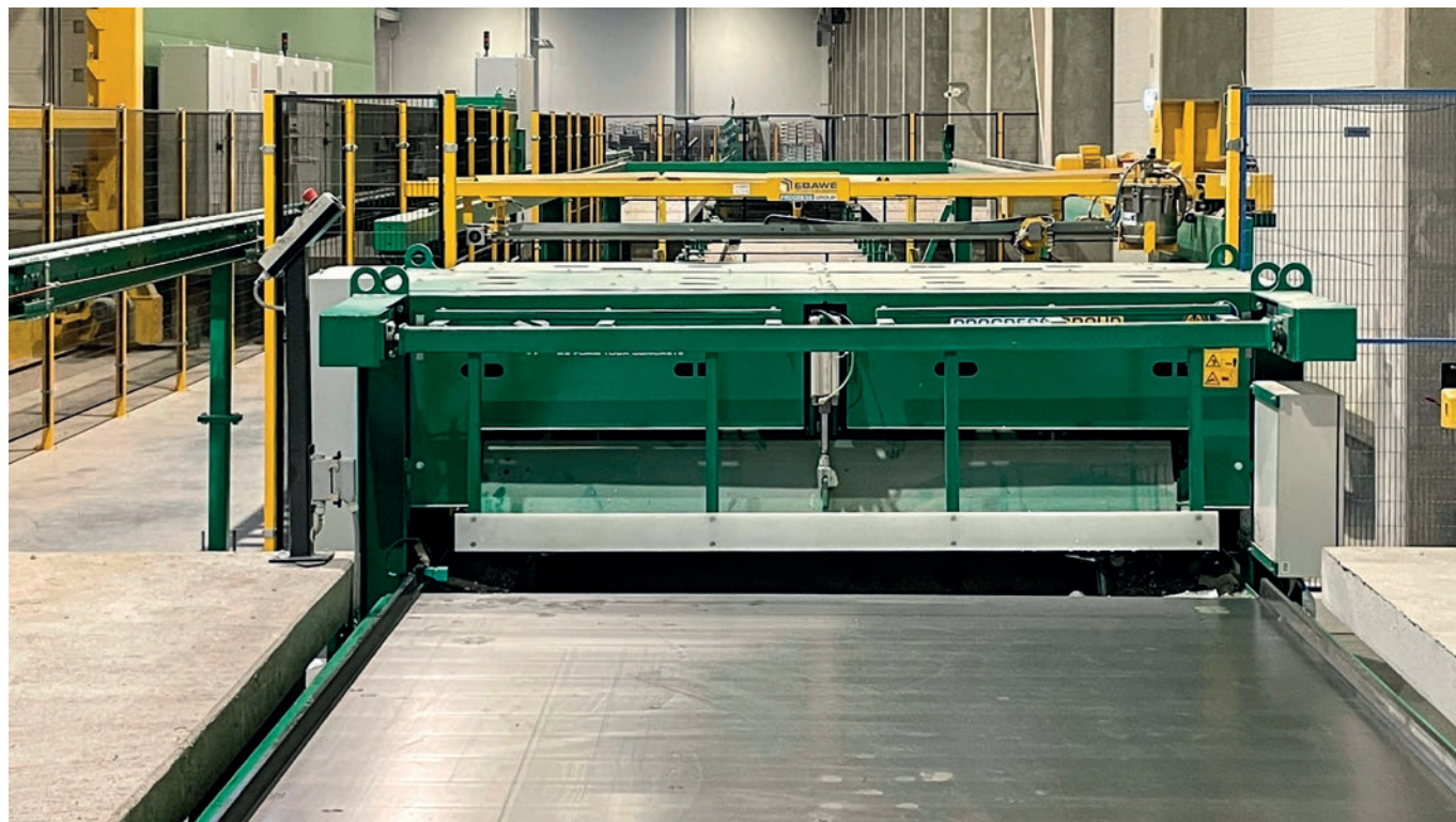
Przed ponownym wykorzystaniem na linii obiegowej podkłady są automatycznie czyszczone.
