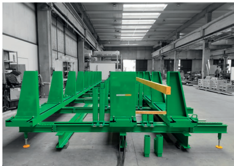
Bateryjne formy dwuelementowe są wykorzystywane do produkcji najlepiej sprzedającego się towaru – słupów – i mają długość 14 metrów.
