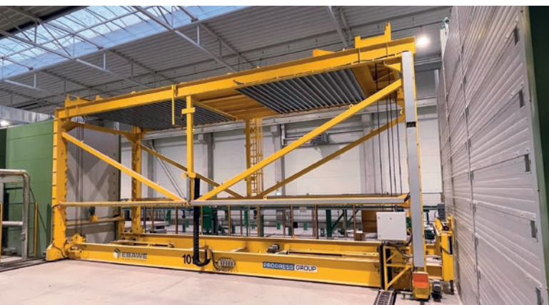
Sztaplarka podkładów wkłada świeżo wyprodukowane elementy do regału dojrzewania.
