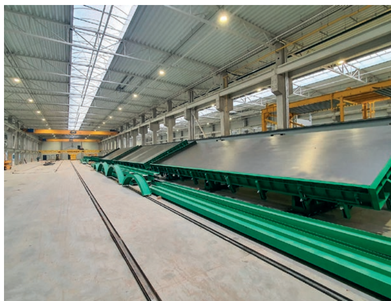
Stoły uchylne służą do produkcji wielkowymiarowych płaskich prefabrykatów betonowych, takich jak ściany pełne lub ściany warstwowe.
