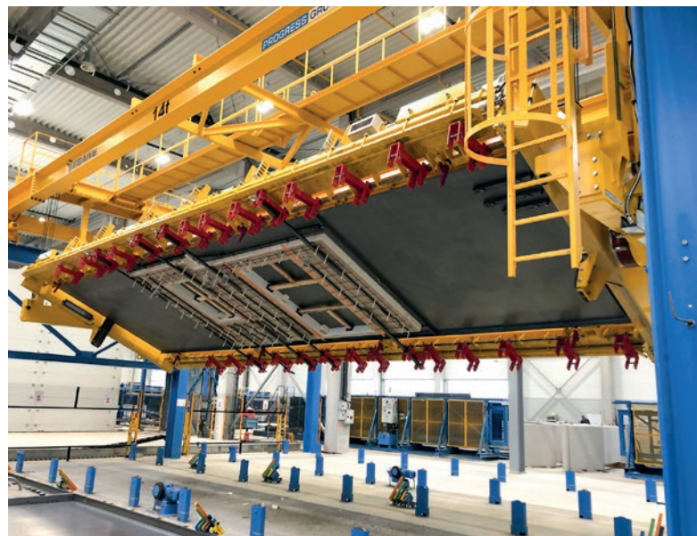
Urządzenia do odwracania firmy Ebawe Anlagentechnik są w pełni zautomatyzowane i pracują z dokładnością co do milimetra.
