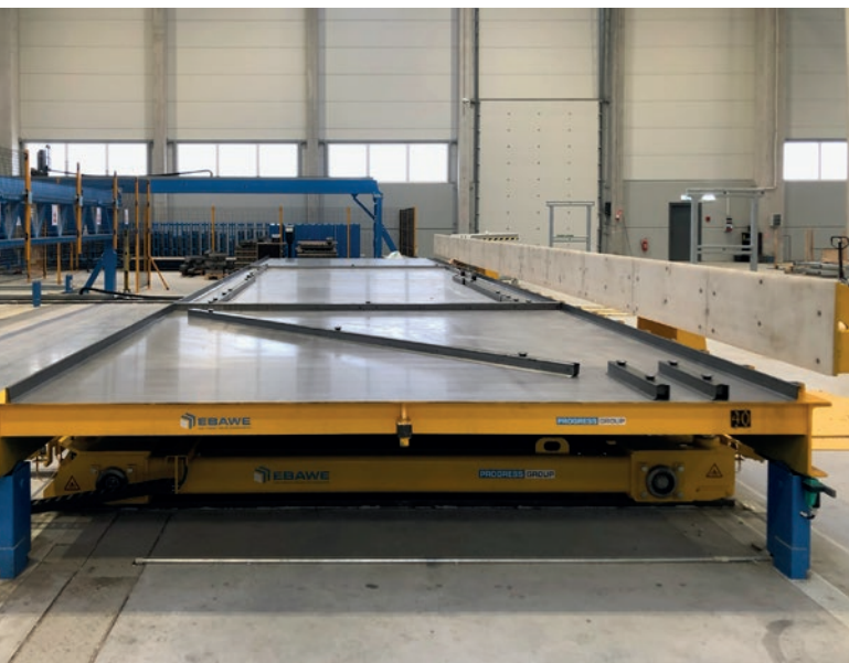
Profile szalunkowe są umieszczane dokładnie tam, gdzie trzeba, na podkładzie produkcyjnym – zgodnie z projektem, w pełni automatycznie i w krótkim czasie.
