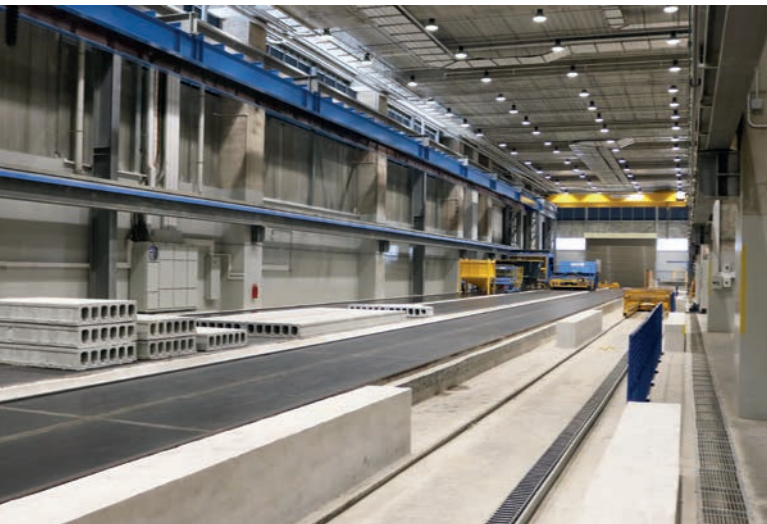
Greyform 公司在三个机床上运用 S-Liner T40 滑模机来制造空心板和预应力构件
