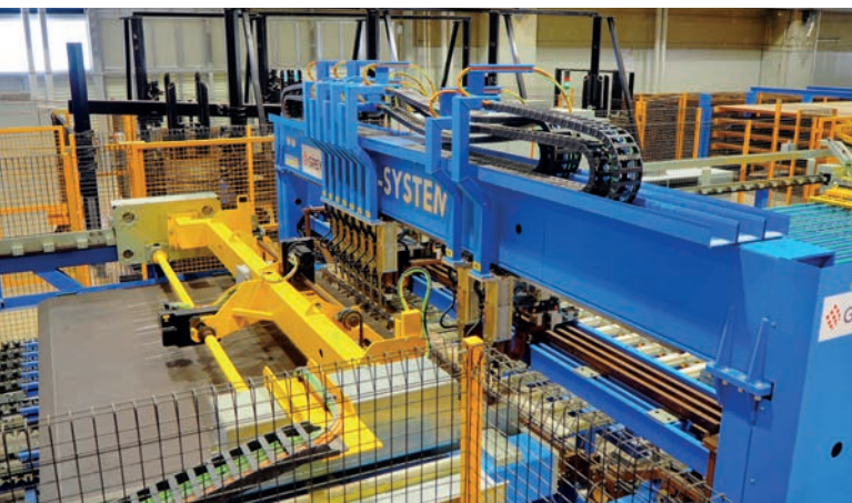
定制的测量网格在工厂一楼制造。M-System Evolution 网格焊接设备已经被研制出来，使工厂生产尽可能地灵活，并且完美融入整体概念
