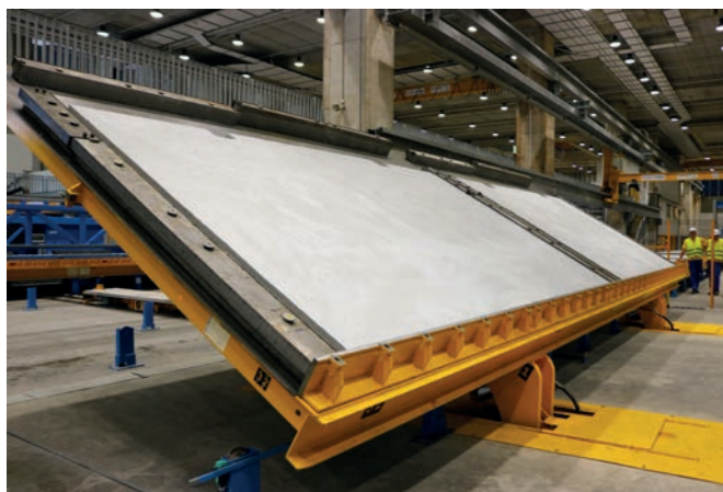
生产周期结束时，成品实体墙或地板将从托盘上移出，并自动被运送至仓库
