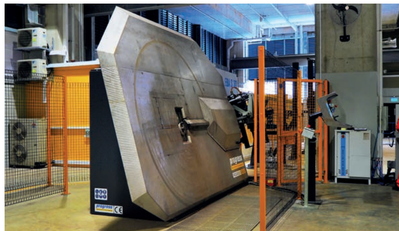
EBA S16 Plus 3D 自动箍筋弯曲机用于制造弯曲钢筋、箍筋和 3D 箍筋
