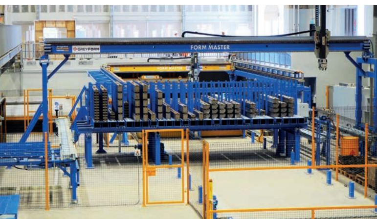
高度自动化的旋转设备（图中为组模和脱膜机器人）使 Greyform 公司雇用一小部分工人就能实现精确的交货期和最高的质量要求
