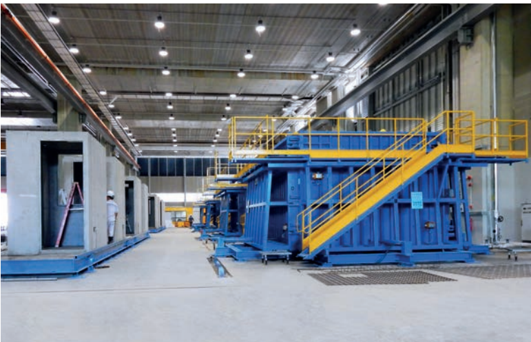
Greyform 公司运用四个 3D 模具来生产房间构件，用于预制厨房和浴室的安装
