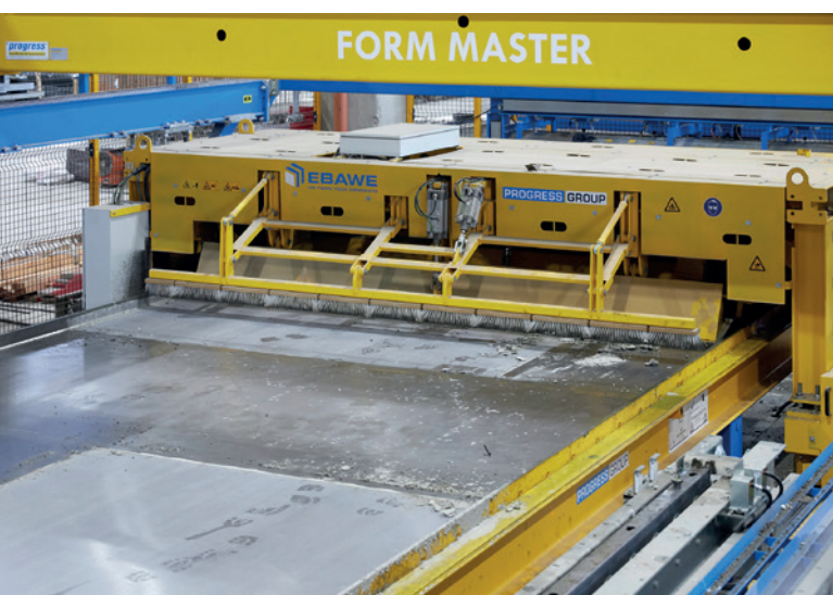
HTB Hoch- und Tiefbaustoffe GmbH & Co KG 公司位于科嫩的新型循环工厂, 在去模板化之后通过托盘清洁装置对托盘表面进行优化式清洁
