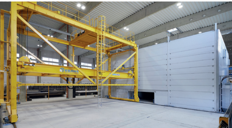
堆放架可容纳 36 个托盘，并配备了一个升降式转运台对其进行辅助
