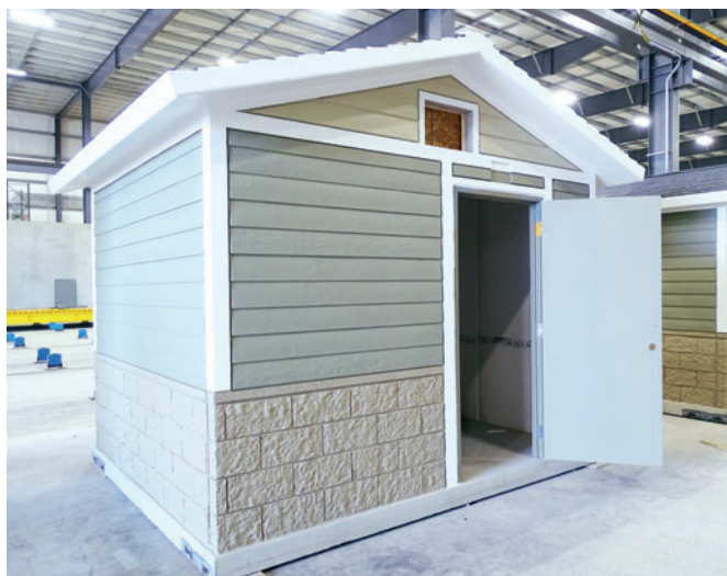
Huffcutt stellt Sanitärhäuser aus massiven Betonelementen her und baut diese direkt im Werk zusammen, bereits komplettiert mit sämtlichen Sanitäranlagen. Gestaltet werden die kleinen Gebäude in architektonischen Designs mit Farbbeton und Matrizen in Fliesen-, Stein- und Holzoptik.
