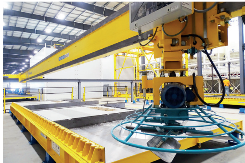
用动力抹刀进行细刨，在没有后续处理的情况下使得混凝土表面很光滑且适于刷色
