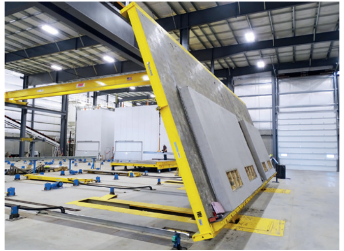
借助倾斜装置，使墙体构件倾斜，便于在之后的安装位置进行拆卸
