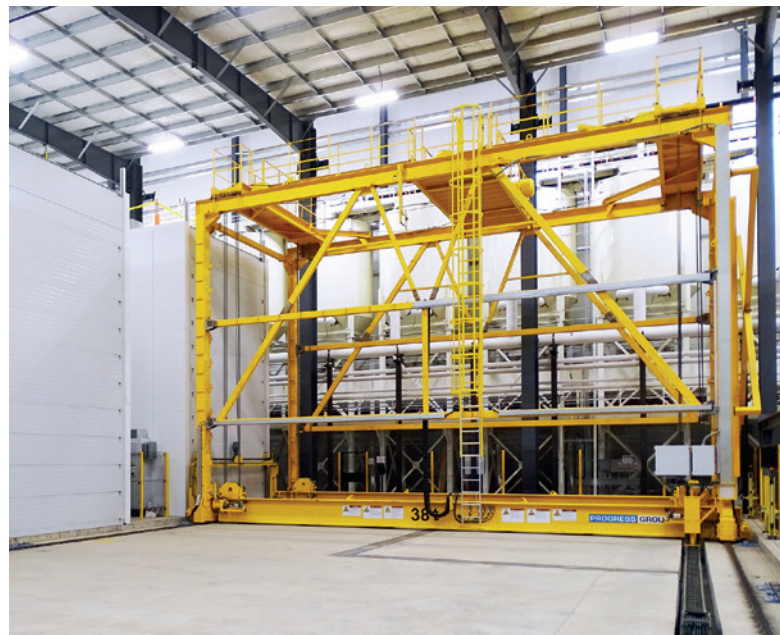
托盘堆垛机服务于两个机架，存储或取回新鲜的混凝土实心墙壁构件
