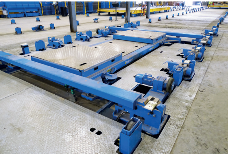
组合式压实设备可将托盘垂直或水平移动，使客户在最终产品中有较大的灵活性
