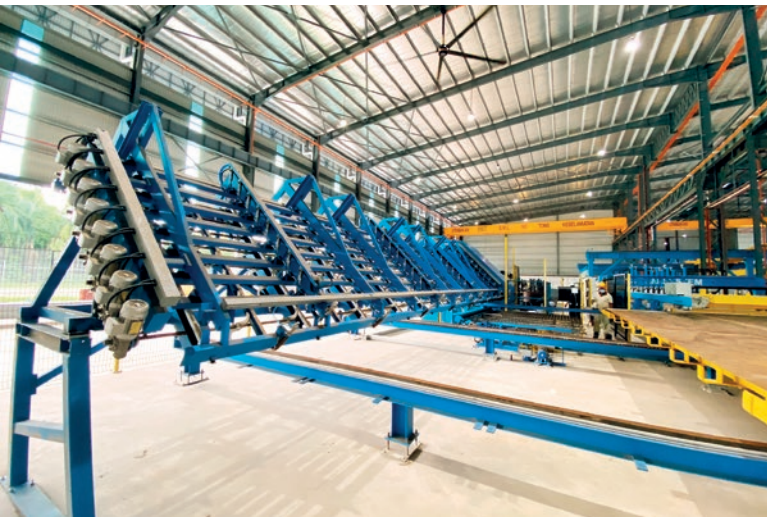
M-System Evolution to zaawansowany automat do zgrzewania siatek, który produkuje niestandardowe siatki zbrojeniowe wykorzystywane w produkcji prefabrykatów.
