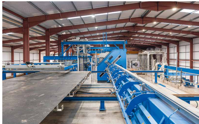
M-System BlueMesh® 网格焊接设备确保快速生产预制构件的钢筋
