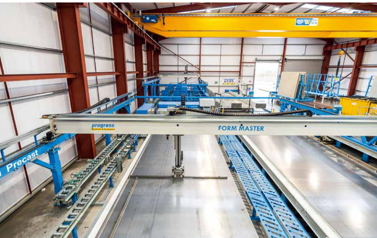
Form Master 模板机器人将模板完全自动化且精确地放置在托盘表面上，并且无需任何事后必须处理的填充元件
