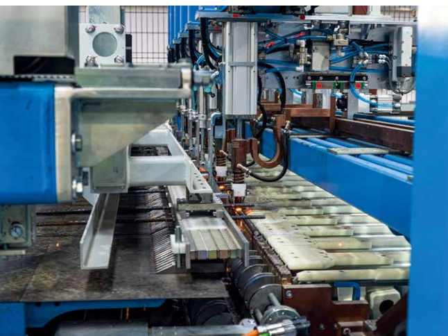
无浪费地生产线和交叉线 - 通过直接从线圈工作 - 无需将网切割成一定尺寸，也无需铺设工作，也优化了生产流程
