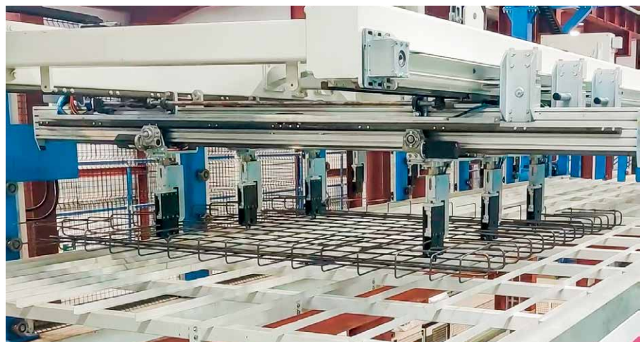
创新的横向夹持器即使对于特殊弯曲的网格和笼子也能实现自动化物流过程
