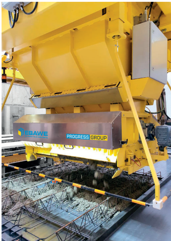
Der neue Betonverteiler arbeitet schnell und präzise bei der Produktion von Doppelwänden mit und ohne Isolierung, Elementdecken sowie Massivwänden in sehr hoher Qualität.
