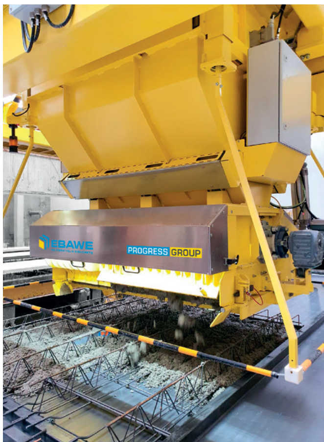
新型混凝土摊铺机可快速、精确地生产高品质的配备或不配备隔热层的预制双层墙，带有现浇罩面的预制板和实心墙
