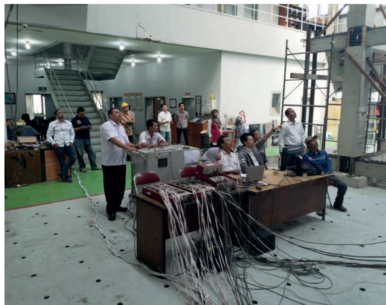
由预制混凝土构件建成的建筑正在建筑材料测试机构接受地震测试
