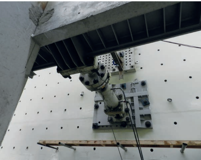
样板房正接受 2500 年一遇的地震强度测试，相当于里氏震级 8 级以上
