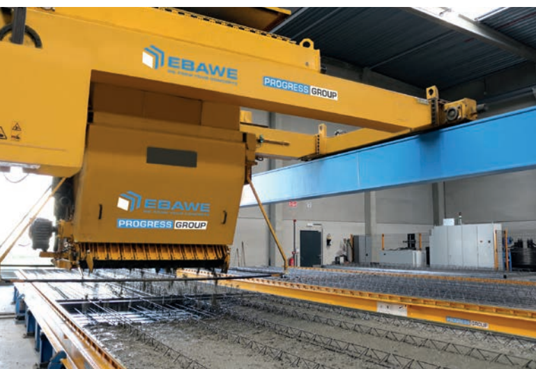
全自动混凝土摊铺机确保混凝土均匀合理地摊铺到模具中
