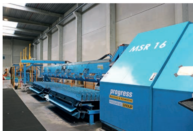
Progress MSR 16 矫直和弯曲机可以脱离线圈工作, 并优化生产流程; 降低储存成本, 简化材料处理, 进而保障经济高效的生产
