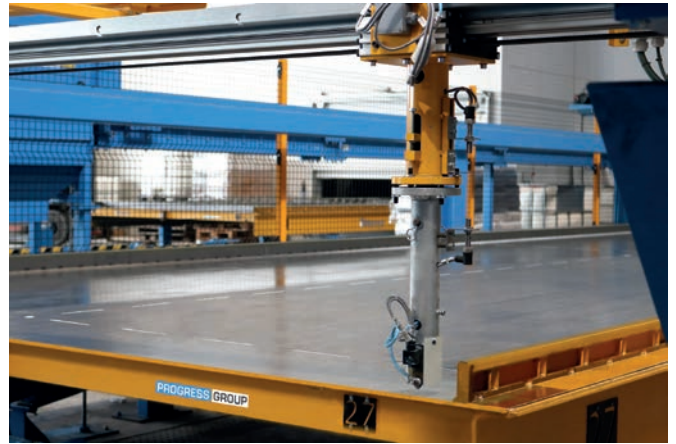
在绘图仪的帮助下，预制板接头、电箱或其他构件都放在托盘上，使得手动关闭程序的过程精确且省时
