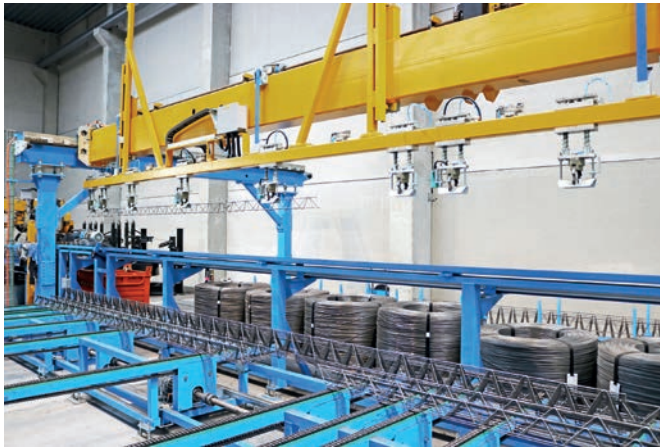
VGA Versa 系列的 Progress 格栅焊接和搬运机代表了最灵活的生产工艺，可以实现即时的格栅生产
