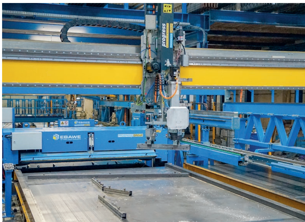
Robot rozformowujący całkowicie automatycznie zdejmuje szalunki z podkładu, zanim trafi on dalej na stanowisko czyszczenia.
