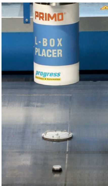
Specjalnie opracowane dla firmy Schwörer urządzenie rozmieszcza magnesy i płyty z włókien mineralnych do elementów instalacji elektrycznej.
