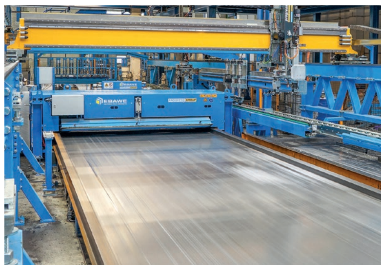
Urządzenie czyszczące podkłady od firmy Ebawe stanowi część nowego robota szalunkowego.
