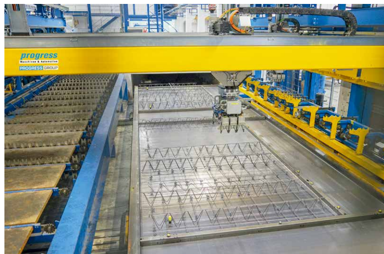
线材中心根据 CAD 规范铺设带有或不带有垫片的横向钢筋以及纵向钢筋和桁架梁
