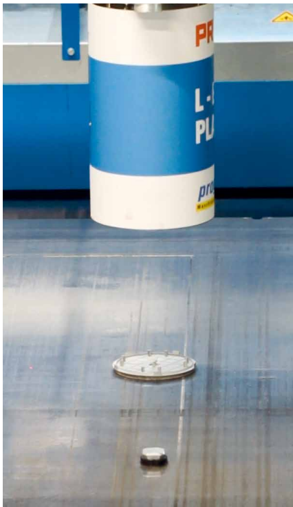
专为 Schwörer 开发的设备可放置用于电气安装的磁体和矿物纤维板
