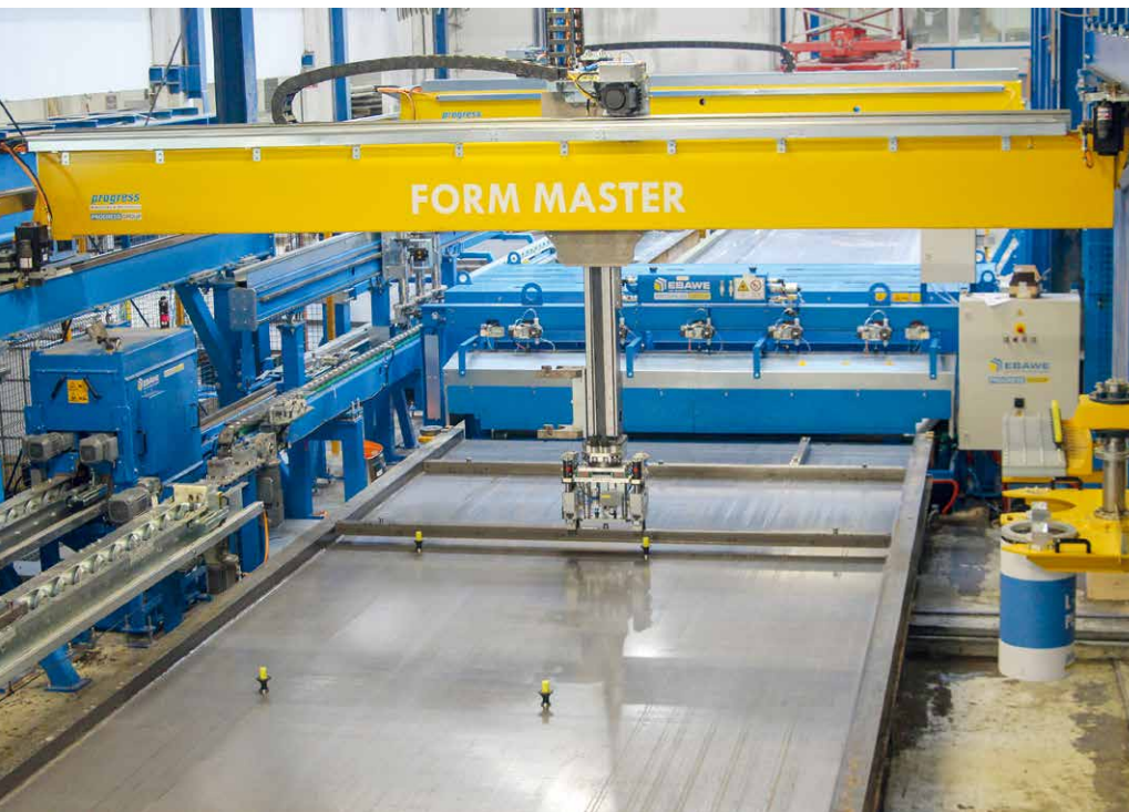
Schwörer 的个性化的模板机器人精准地将模板、磁体和装配套筒放在托盘上
