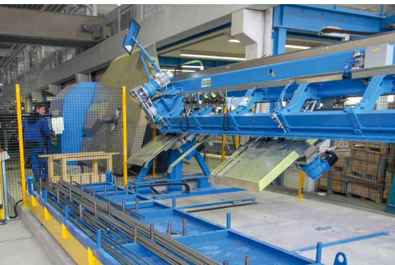
Pluristar 自 2021 年初起在 SchwörerBausysteme GmbH 投入运营，这是一款用于卷钢全步骤加工的多功能机器
