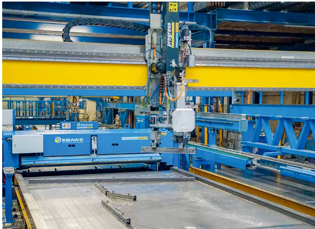
脱模机器人会在将托盘送至清洁设备之前全自动移除模板
