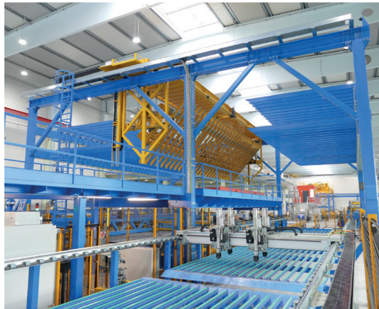
磁性横梁根据 CAD 规范将钢筋网插入托盘中，用作中间缓冲，当纵杆必须位于横杆上方时可以翻转钢筋网，并将钢筋网放置在堆垛车上
