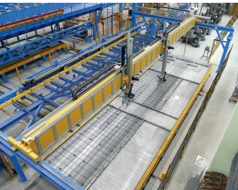
多轴线性机器人使 Eder 新工厂的自动化钢筋区域更加完美
