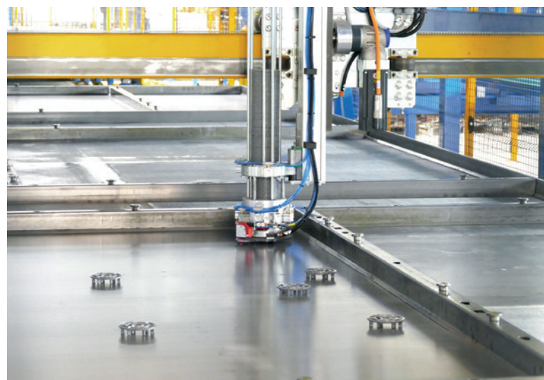
通过使用 MeshSpacer 全自动垫块铺设机，Eder 节省了大量成本
