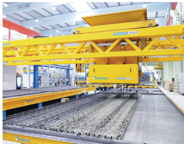
新型 eCon® Drive 自动混凝土布料机具有很高的卸料速度和出色的混凝土配料能力
