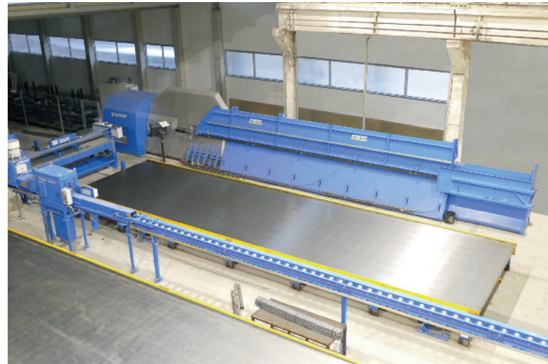
Pluristar firmy progress Maschinen & Automation to wielofunkcyjny automat zbrojarski zawierający trzy maszyny w jednej: automat do produkcji strzemion, prościarko-obcinarkę i maszynę do zaginania końców prętów. Został idealnie zintegrowany z nową linią obiegową Ebawe.
