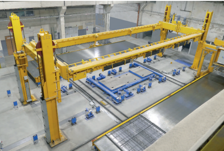
Centralnym elementem linii obiegowej w produkcji ścian zespolonych jest urządzenie do odwracania podkładów.
