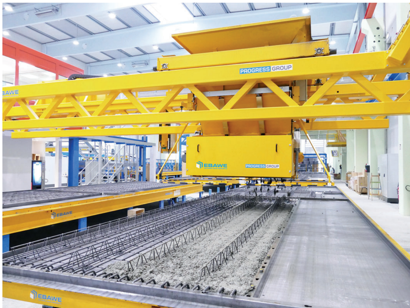
Elevada velocidade de descarga aliada a uma excelente capacidade de dosagem do concreto devido ao novo distribuidor de concreto automático eCon® Drive
