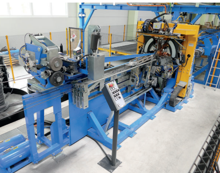
Com a máquina automática para a produção de treliças eletrossoldadas altamente flexível VGA Versa, as treliças são produzidas na hora certa, sendo que a Eder registra elevado potencial de poupança na logística, custos de armazenagem e desperdício.
