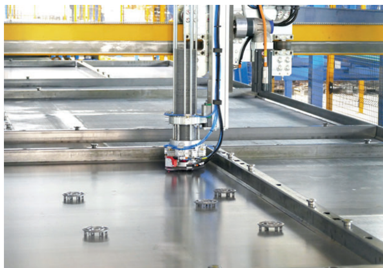
Mediante a colocação totalmente automática de espaçadores com o MeshSpacer, a Eder atinge elevadas economias.
