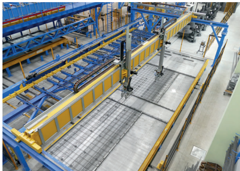
Um robô linear multieixo complementa a área de produção de armaduras automatizada na nova fábrica da Eder.
