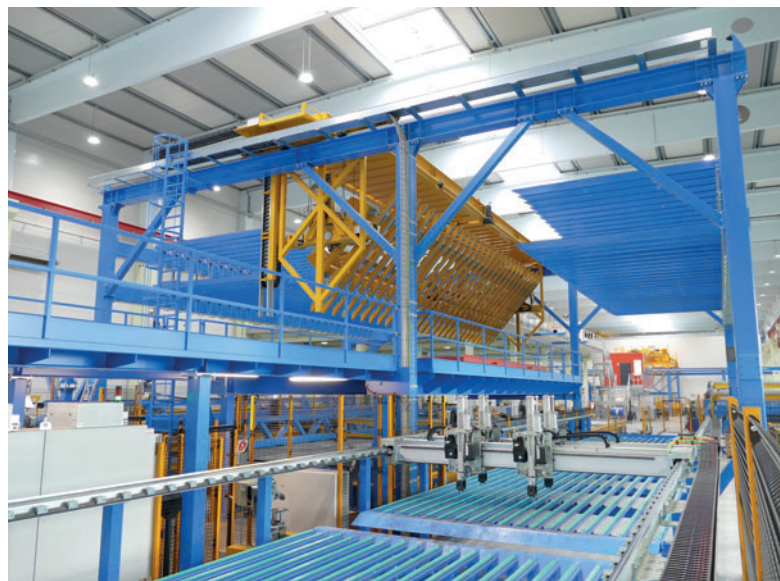
A travessa magnética insere as malhas de acordo com a definição CAD nas paletes, opera a reserva intermediária, consegue virar as malhas, quando as barras longitudinais têm que se encontrar sobre as barras transversais e coloca as malhas sobre uma empilhadeira.
