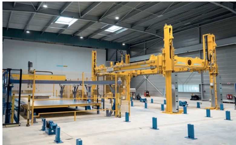
Durch die neue Wendeeinrichtung werden zeitgleich zwei Paletten aufgenommen und um 180° gewendet. Dadurch wird die Möglichkeit geschaffen, auf der Oberseite des Holzbetonelements eine Tragstruktur aus Normalbeton aufzubringen.
