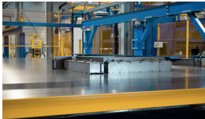
Das neue Herzstück der Anlage bei Spurgin: das PreFix Schalungssystem.
