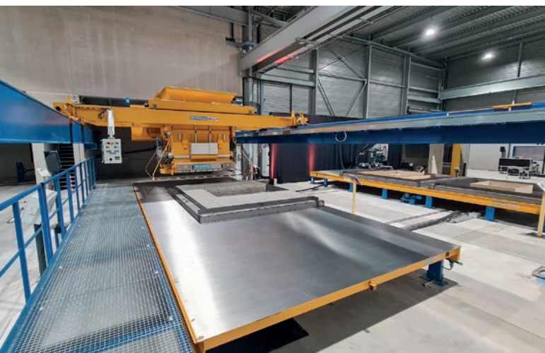
Nowo opracowany rozścielacz służy do rozprowadzania mieszanki trocinobetonowej.
