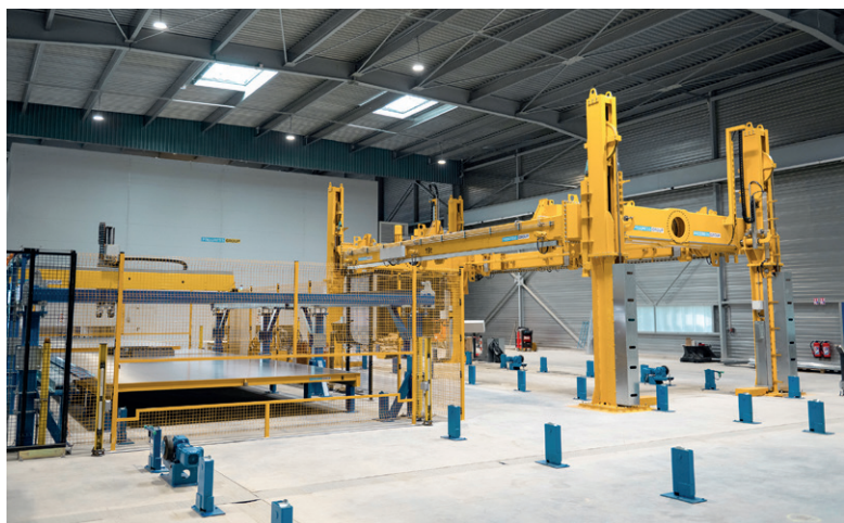
新型翻转设备可同步抓取双托盘进行 180° 旋转，实现在木混凝土构件顶部浇筑普通混凝土承重层的创新工艺
