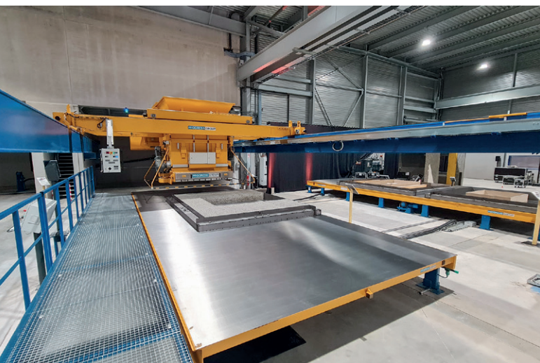
新型混凝土布料机专为木混凝土卸料工艺设计
