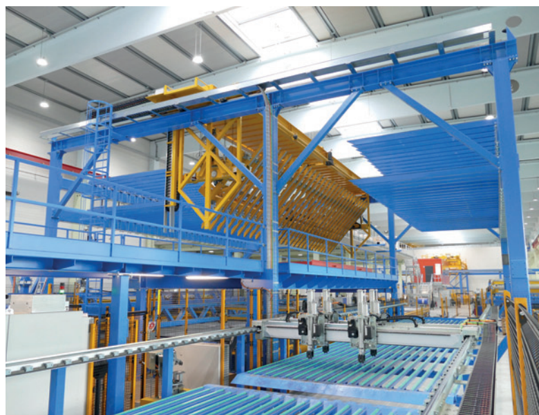
Trawers magnetyczny układa siatki zgodnie z danymi CAD na podkładach, obsługuje bufor siatek, obraca siatki, jeśli pręty podłużne muszą znajdować się nad prętami poprzecznymi, i odkłada siatki na wózek transportowy,
