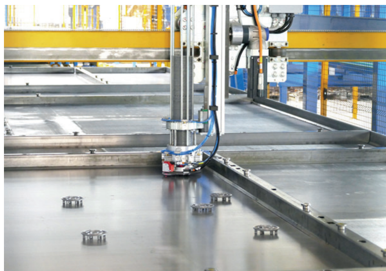
Firma Eder oszczędza sporo materiału dzięki automatycznemu układaniu elementów dystansowych za pomocą urządzenia MeshSpacer.
