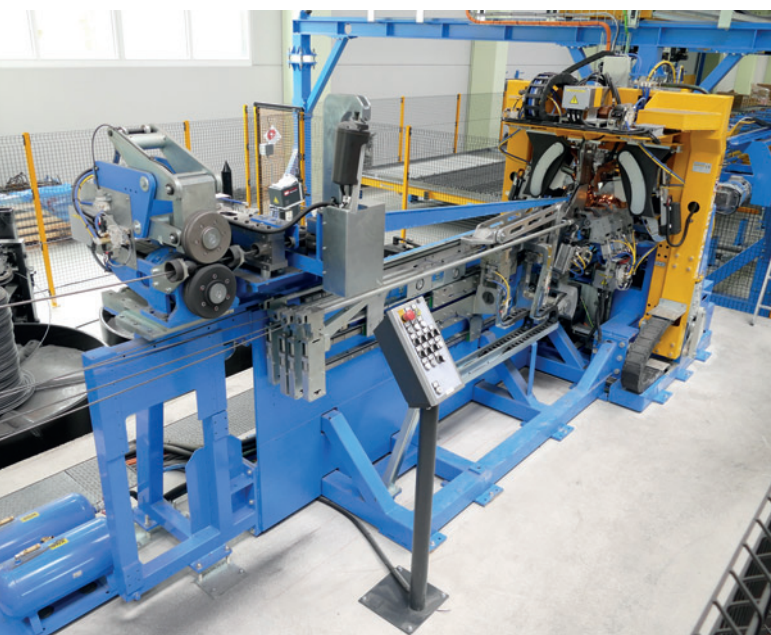
Za pomocą wysoce uniwersalnej zgrzewarki VGA Versa kratownice są produkowane na bieżąco, dzięki czemu firma Eder oszczędza dużo nakładów logistycznych, kosztów magazynowania i kosztów związanych z odpadami.
