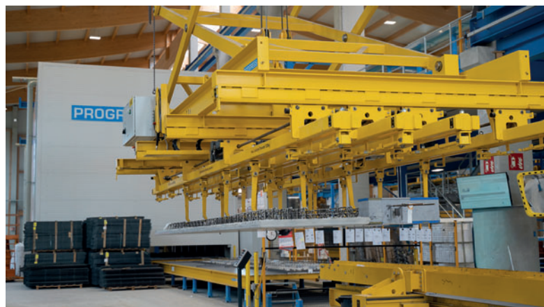
С помощью подъемной траверсы готовое изделие снимается с поддона и подготавливается к дальнейшей транспортировке
