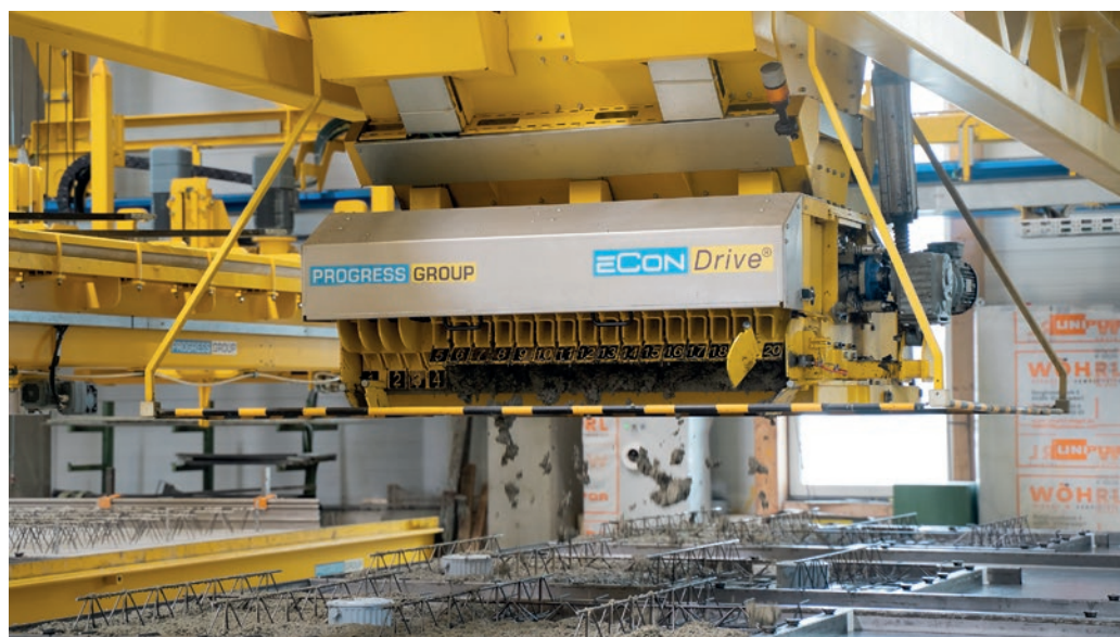
Le distributeur de béton eCon Drive est équipé de demi-vannes, ce qui permet un déchargement du béton encore plus précis.
