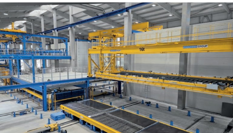
Le dispositif de retournement automatique est utilisé pour la production de prémurs.
