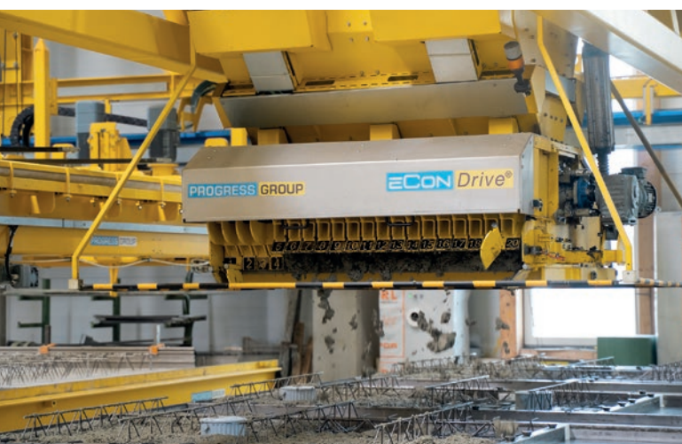
Rozścielacz mieszanki betonowej eCon Drive jest wyposażony w półkłapy, które pozwalają na jeszcze bardziej precyzyjne podawanie mieszanki betonowej.
